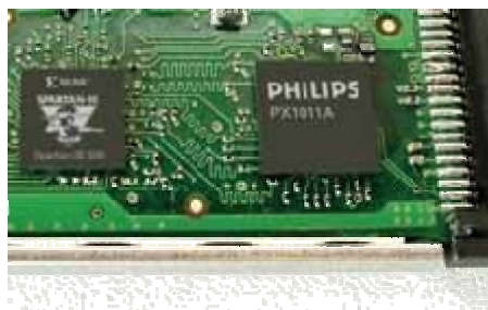
图 3：DVB-T ExpressCard/34 演示设备上的赛灵思 Spartan-3E FPGA 和飞利浦 PX1011A
