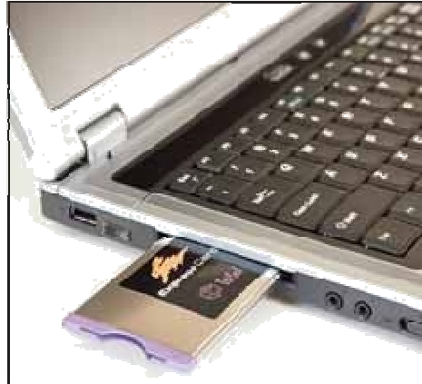
图 1: (a) 笔记本电脑和 (b) 桌面计算机中的 ExpressCard 模块 (照片复制经过 PCMCIA 允许)
