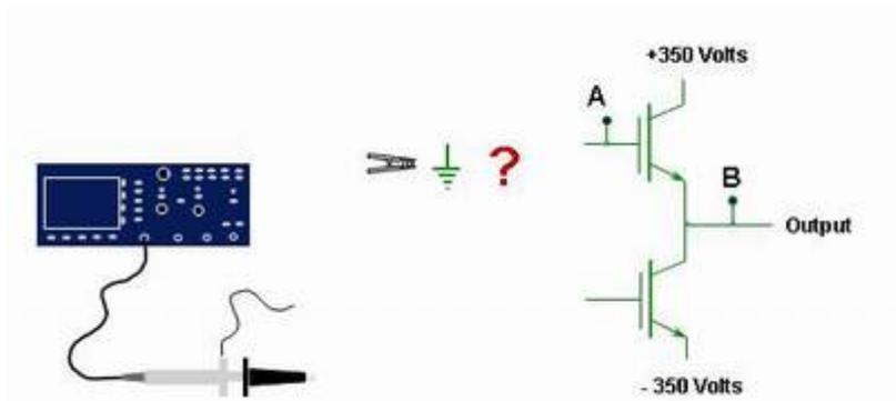
剪断地线可以防止对 MOSFET 管测试中的短路问题，但是也会带来一些其它的测试问题，比如示波器机壳带电，示波器机壳分布参数对测量信号造成影响等。解决的办法是使用差分探头，比如泰克的 P5205，可以测量所谓的 2 个测试点都不是地的差分信号。
