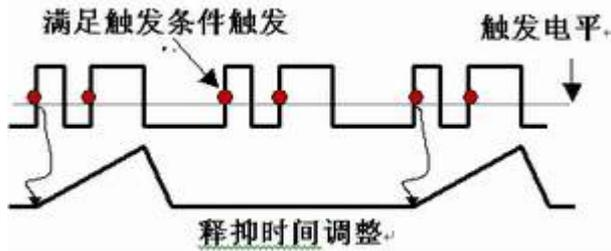
示波器的触发部分的作用就是稳定的显示波形，触发释抑也是为了稳定显示波形而设置的功能。主要针对大周期重复而在大周期内有很多满足触发条件的不重复的波形点而专门设置的。比如图中所示，图中红色的点都可以满足触发条件，如果不用释抑功能，触发点将不固定，造成显示不稳定，使用触发释抑后，每次都在同一个点触发，因此可以稳定显示。此外，对于调幅信号等也一样要使用触发释抑。详情请参见泰克文章《示波器 XYZ》。
