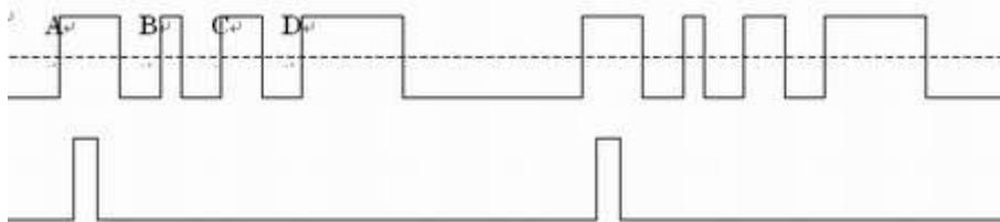
观测上面的信号，由于 ABCD 各点都会触发，示波器显示波形将不能稳定。这时可以使用下面的信号作为触发信号，示波器将得到能够全部周期的显示。
