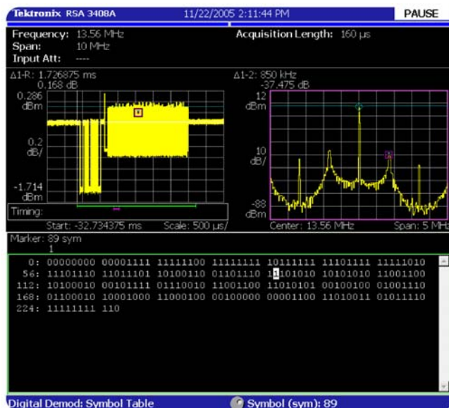
► 图 2. 在 RTSA 的功率随时间变化、频谱域和数据域中检查 13.56 MHz 接近式门禁卡信号交换。
